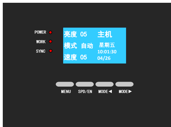
检测正常后自动进入到操作界面
